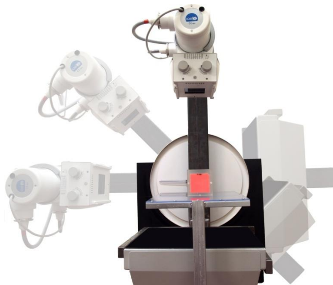
Рис 3. - Зображення створеного скануючого рентгенівського томографа.
